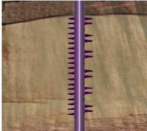
Fig.III.3 : Les perforations de Hiway (droite) et perforations conventionnelles (gauche).
