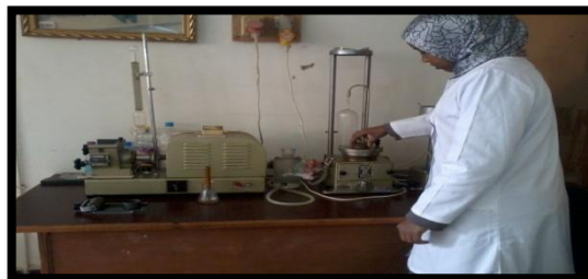
Figure N°15 :L'appareil Alvéographe Chopin
