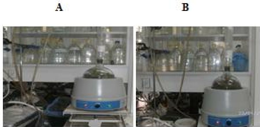
Figure 08 : Montage réel d'hydrodistillation (A) S. terebinthifolius et (B) S. molle
