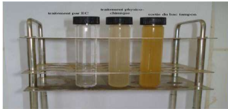
Figure N°10: Résultats obtenus après électrocoagulation et coagulation, floculation et décantation.
