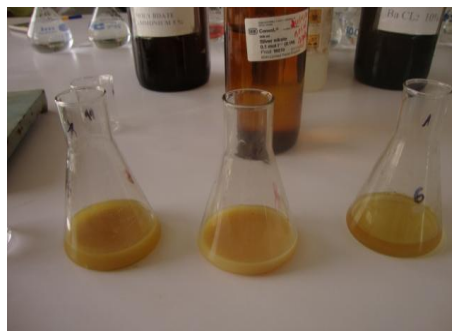
Fig22 : Chromate de potassium coloration brun en milieu basique
