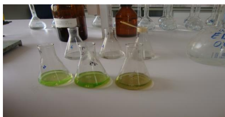
Fig18 : Coloration vert s'explique par la formation D'un complexe de calcine avec \text{Ca}^{2+}
