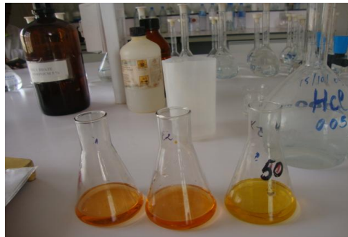
Fig32 : Méthyle orange coloration rouge en milieu acide.
