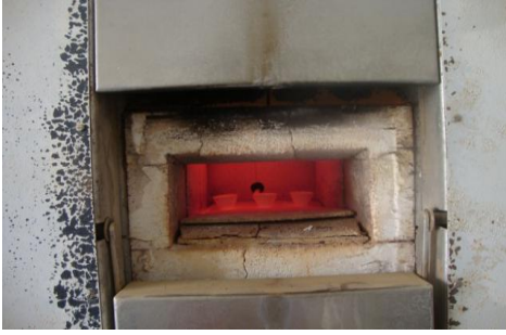
Fig27: Four a moufle : pour la Calcination à T^{\circ} = 900^{\circ}\text{C}
