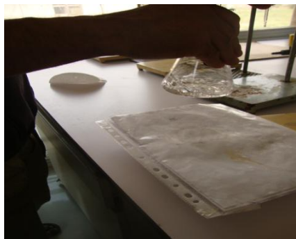
Fig30 : Incolore l'eau analysée ne contient pas de \text{CO}_3^{2-}
