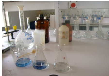
Fig 19: Coloration bleu due à la formation d'un composé De bleu de méthyle thymol avec ( Ca^{2+} + Mg^{2+} ).
