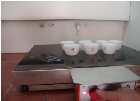
Fig 34: Chauffer à sec à moins de 70°C
