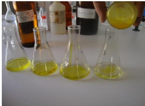
Fig21 : Chromate de potassium coloration brun en milieu acide
