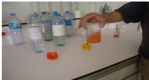
Fig 24: Méthyle orange coloration rouge en milieu acide
