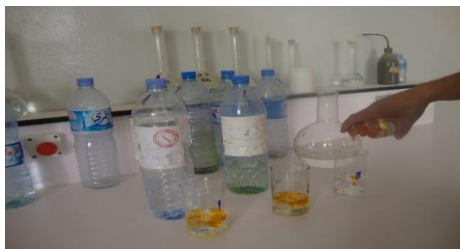
Fig 23: Méthyle orange coloration jaune en milieu basique
