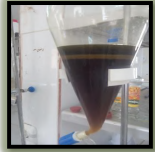
الشكل (5-V): الاستخلاص بـ الايثر البترول
