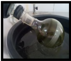
الشكل (4-V): تبخير المذيب بجهاز التبخير
