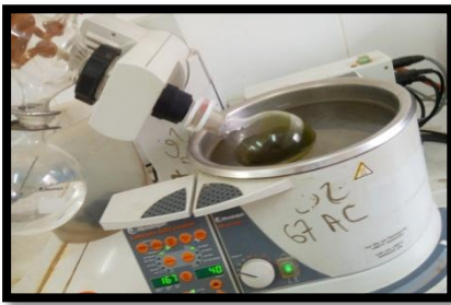
الشكل (2-V): صور لعملية النقع والتبخير بجهاز التبخير والتقطير .
