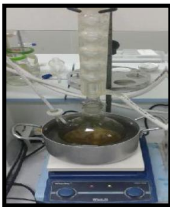
Figure II.5. Montage de la réaction de transesterification
