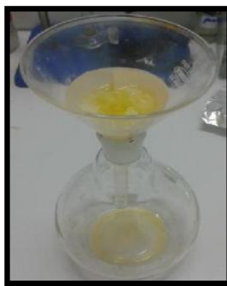
Figure II.8. Filtration du biodeisel
