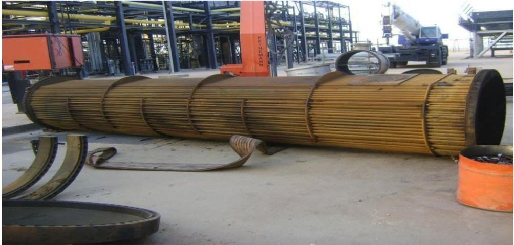
Figure III.6 : faisceau tubulaire.
