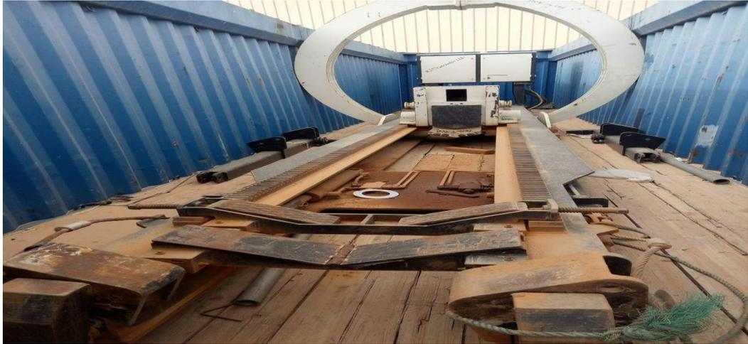
Figure III.15 : Extracteur faisceau.
