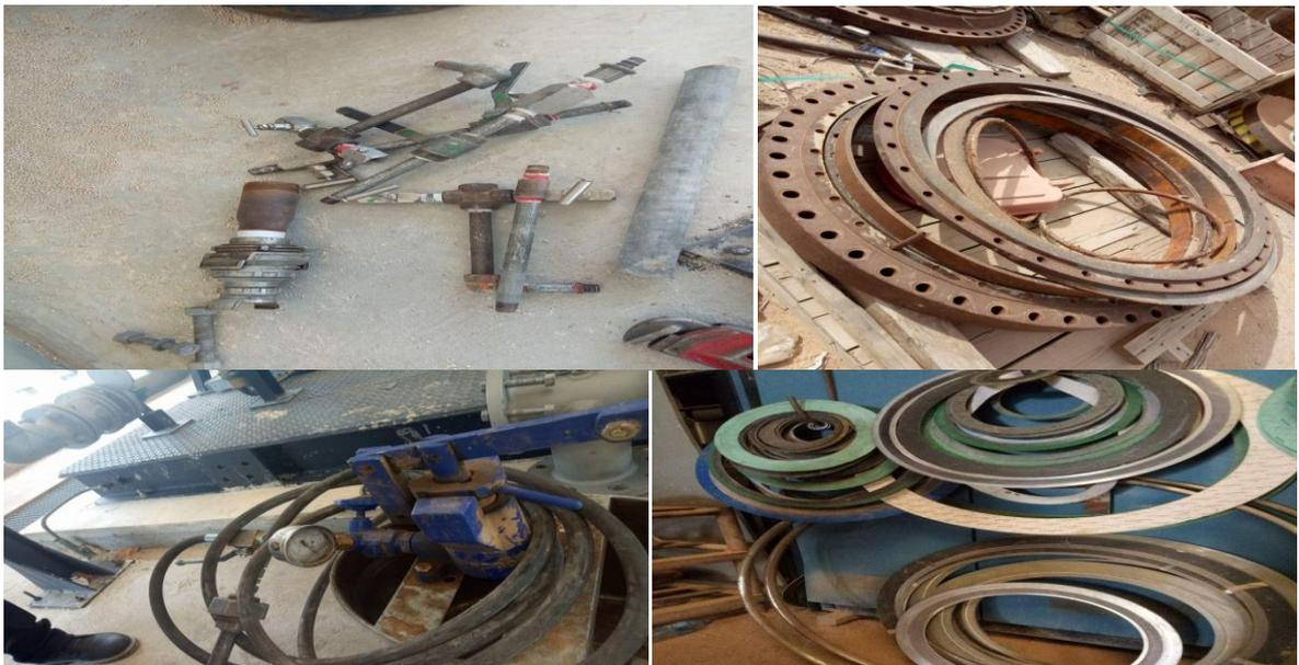
Figure III.16 : Quelques équipements utilisés dans le test hydrostatique.
