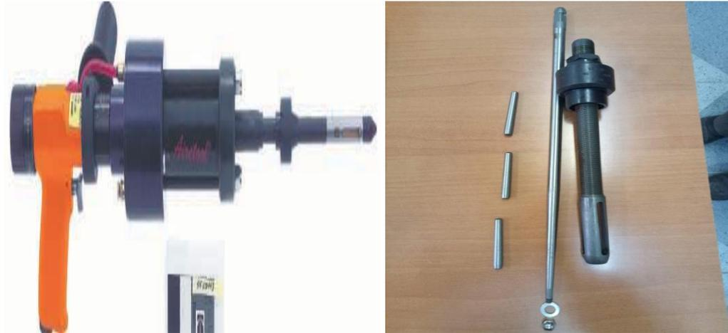
Figure III.14 : Outil de dudgeonnage des tubes.
