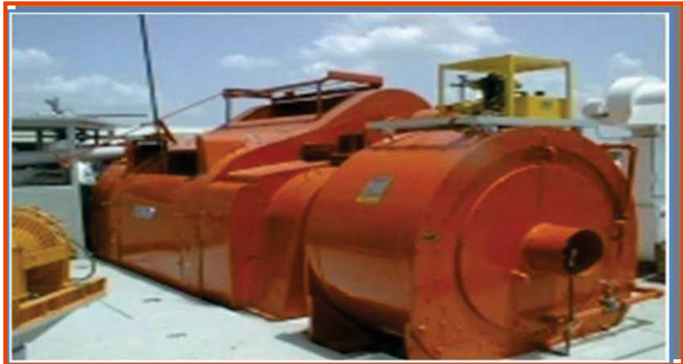
Fig. I.5 : Treuil de forage
