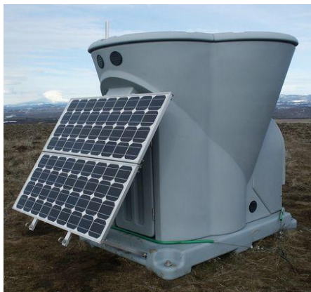
Fig. II-5 : LIDAR pour mesurer le vent
