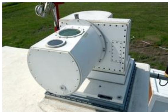
Fig. II-6 : SODAR pour mesurer le vent
