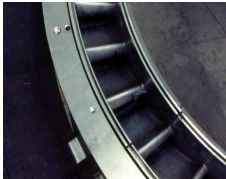
Figure II.7 : schéma de directrice de premier étage
