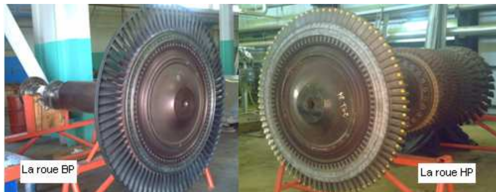
Figure II.9 : Schéma de rotor HP et rotor BP
