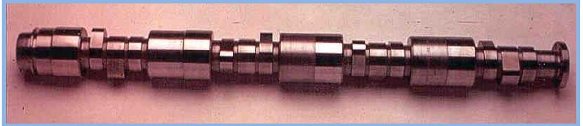
**Fig. II.8 : Arbre à cames d'un moteur CAT**
