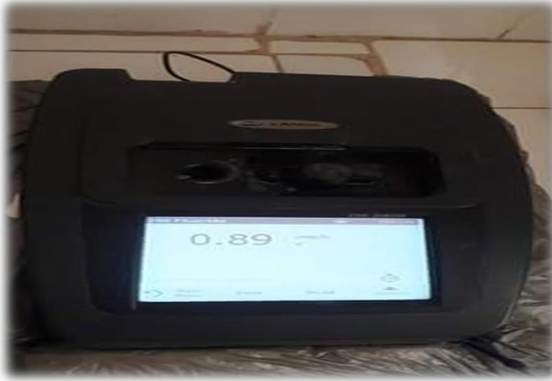
الشكل رقم (20): يمثل صورة لجهاز مطيافية الأشعة فوق بنفسجية (UV-VIS)
