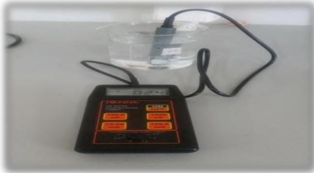
الشكل رقم (14) :يمثل صورة لجهاز قياس الناقلية
