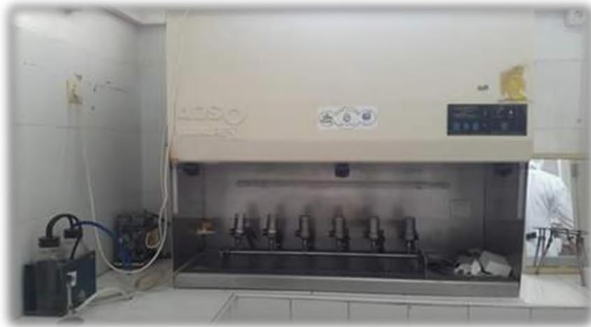
الشكل رقم (24) : يمثل صورة لجهاز المفرغة الهوائية
