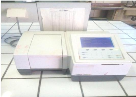
**Dosage d'azote par appareil spectrophotomètre**
