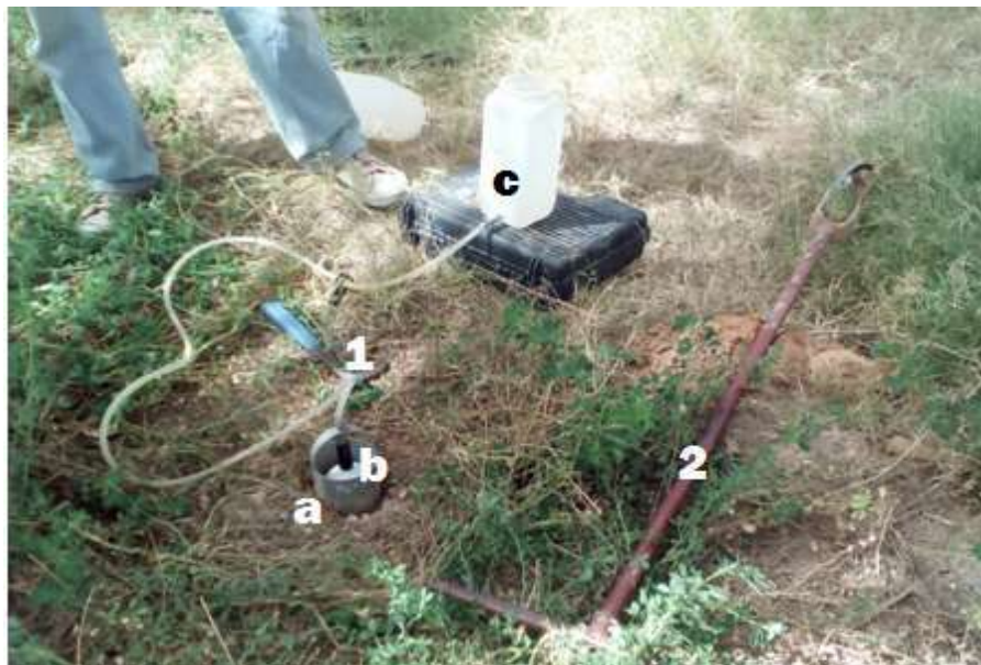
Photo 1 : Perméamètre de Viguiet installé.
