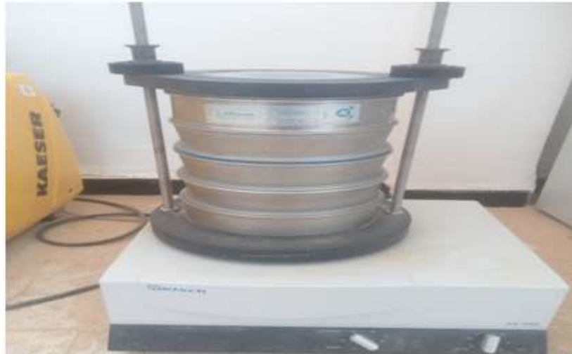
Photo 2 : Une série des tamis (500, 200, 45 \mu ) sur l'agitateur mécanique.
