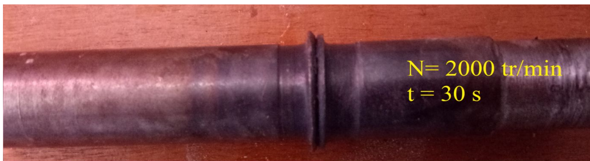
Figure IV.14 : éprouvette en acier A60 avec t=30s et N=2000 tr/min .
