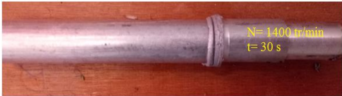
Figure IV.1 : éprouvette en aluminium 2017A avec t=30 s et N= 1400 tr/min.
