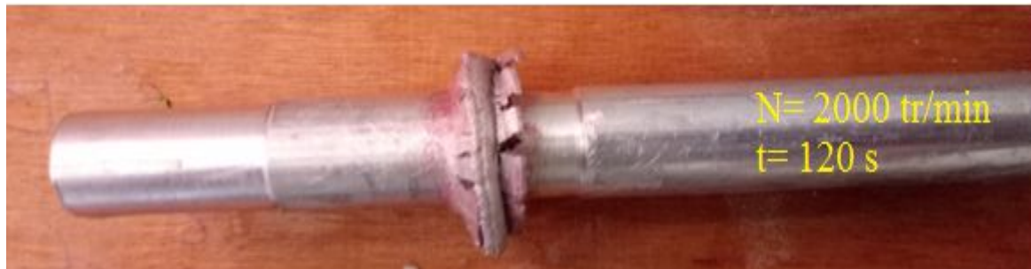
Figure IV.11 : éprouvette en aluminium 2017A avec t=120\text{ s} et N= 2000\text{ tr/min} .
