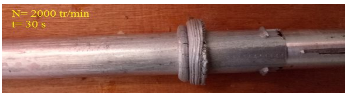
Figure IV.8 : éprouvette en aluminium 2017A avec t=30\text{ s} et N=2000\text{ tr/min} .
