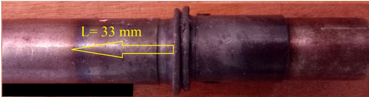
Figure IV.24 : éprouvette en acier A60 avec t=120 s et N=2000 tr/min.
