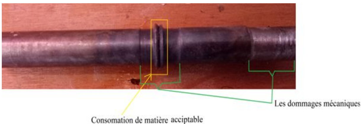
Figure IV.16 : Contrôle par contrôle visuel de l'éprouvette 1 de l'acier A60.
