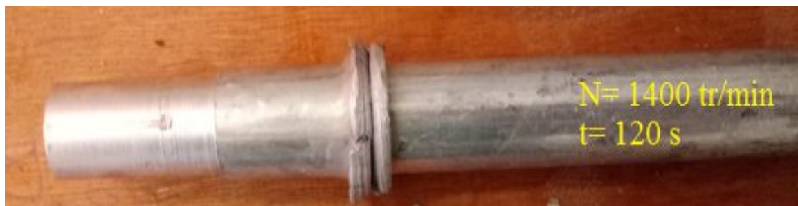
Figure IV.5 : éprouvette en aluminium 2017A avec t=120 s et N= 1400 tr/min.
