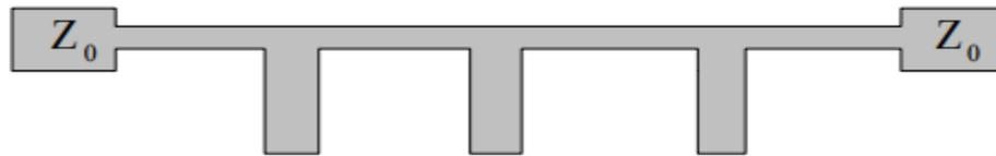
**Figure. II. 12:** Structure d'un filtre à stub en microruban.
