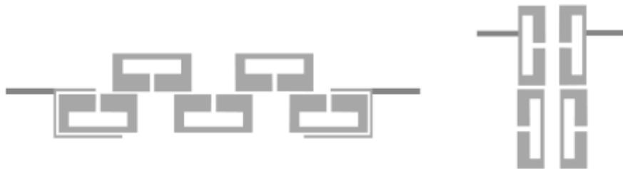
**Figure. II. 16:** présentation de filtres à résonateurs à saut d'impédance couplés.
