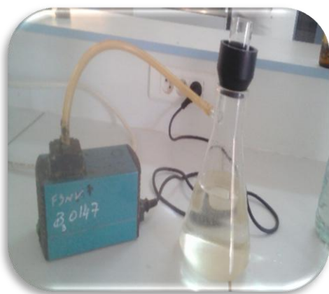
Fig. 28 : photo d'une pompe à vide
