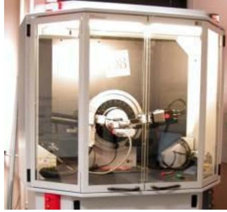
الشكل III-9: جهاز حيود الأشعة السينية D8 Advance Bruker [68].
