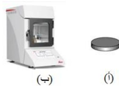
**الشكل III-5:** (أ) حامل العينة، (ب) جهاز الطلي المعدني للعينة [62].
