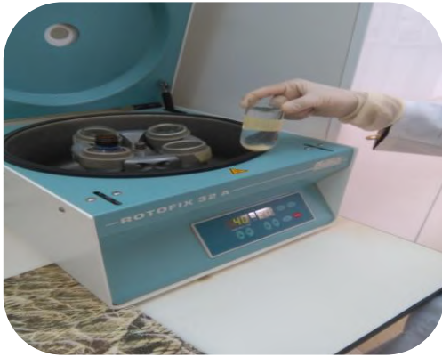
الشكل-42- فصل المحلول عن الطين بجهاز الطرد المركزي
