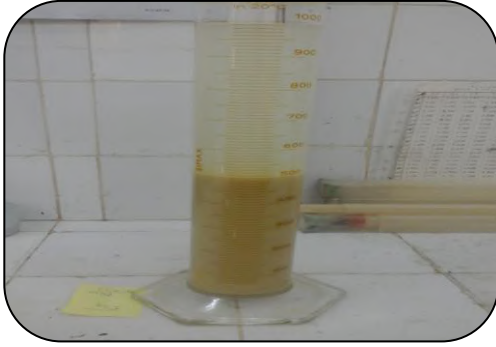
الشكل-21- خليط مسحوق الطين مع محلول 6 (NaPO 3 )
