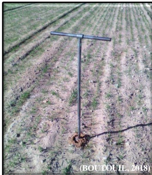
**Photo n° 08** : Tarière utilisée pour l'échantillonnage du sol.
