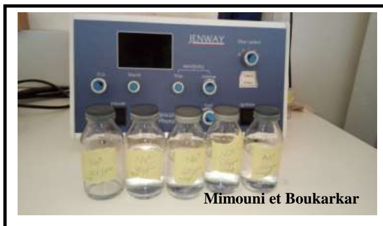
Photo 7 : Dosage des cations Dosage des cations par photomètre à flamme
