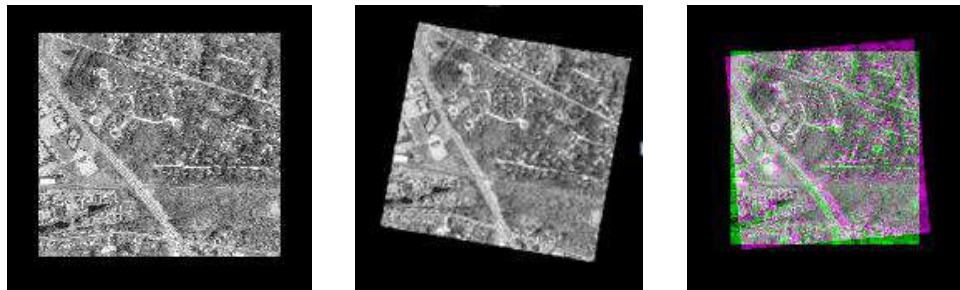
a) Image de référence I_1 b) Image à recalée I_2 c) Superposition de mage I_1 et I_2
