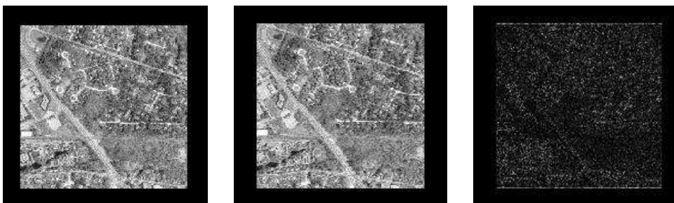
d) Image I_{2\text{recalée}} par MI-PSO e) Superposition de I_1 et I_{2\text{recalée}} f) Image |I_1 - I_{2\text{recalée}}|
