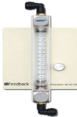
Figure II.11 : Débitmètre (fourni en 2) 38-541-FM [9].
