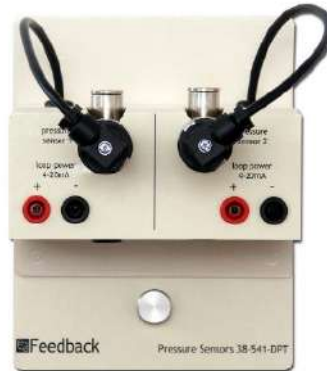
Figure II.5 : Transmetteur de pression 38-541-PT [9].
