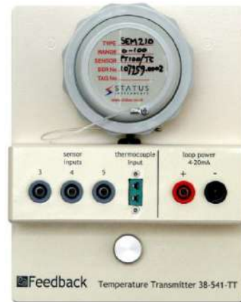
Figure II.7 : Transmetteur de température (SMART) 38-541-TT [9].
