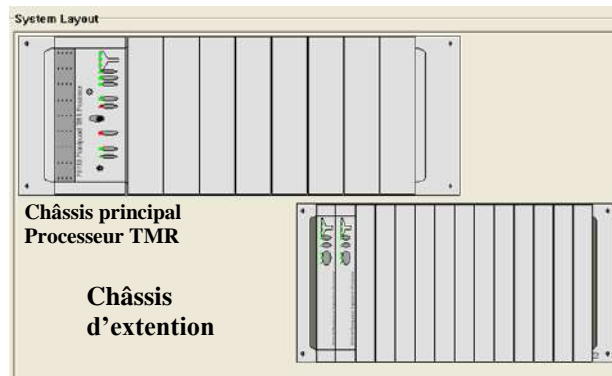
Figure II.10: Insertion d'un nouveau châssis.
