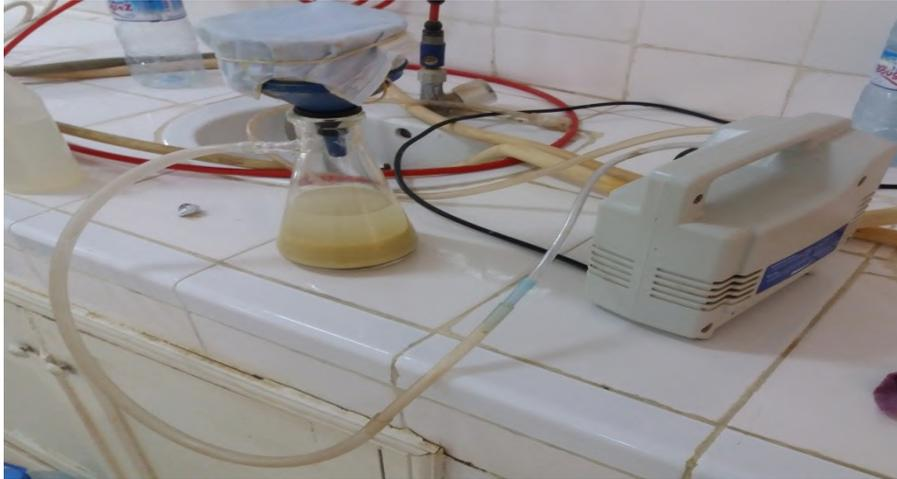
الشكل (35) : تثبيت غربال 2  $\mu\text{m}$  على رأس الارلينة الخاصة بمضخة الترشيح تحت الفراغ و طريقة استعمالها
