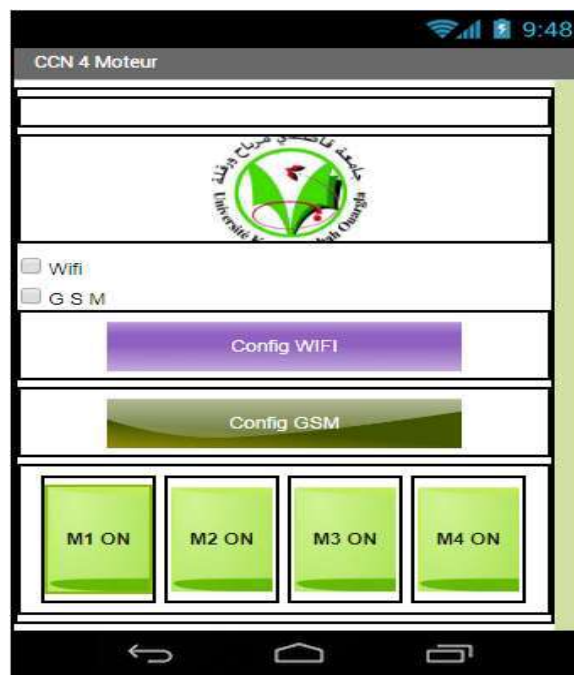
Figure 29: Photo réelle de notre application CCN 4 MOTEUR.
