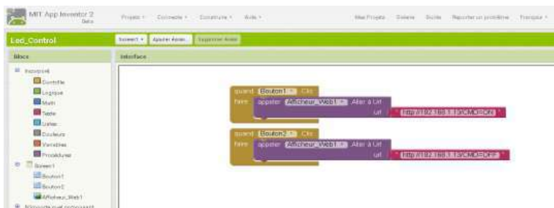
Figure 27: Un bloc pour la gestion du bouton ON et un autre pour le bouton OFF.
