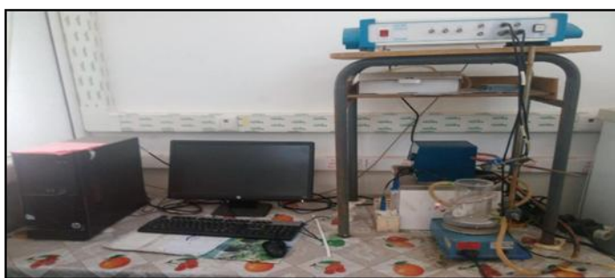
الشكل: جهاز Potentiostat المستعمل في التجربة
