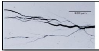
الشكل ٨: تآكل تصدعي
