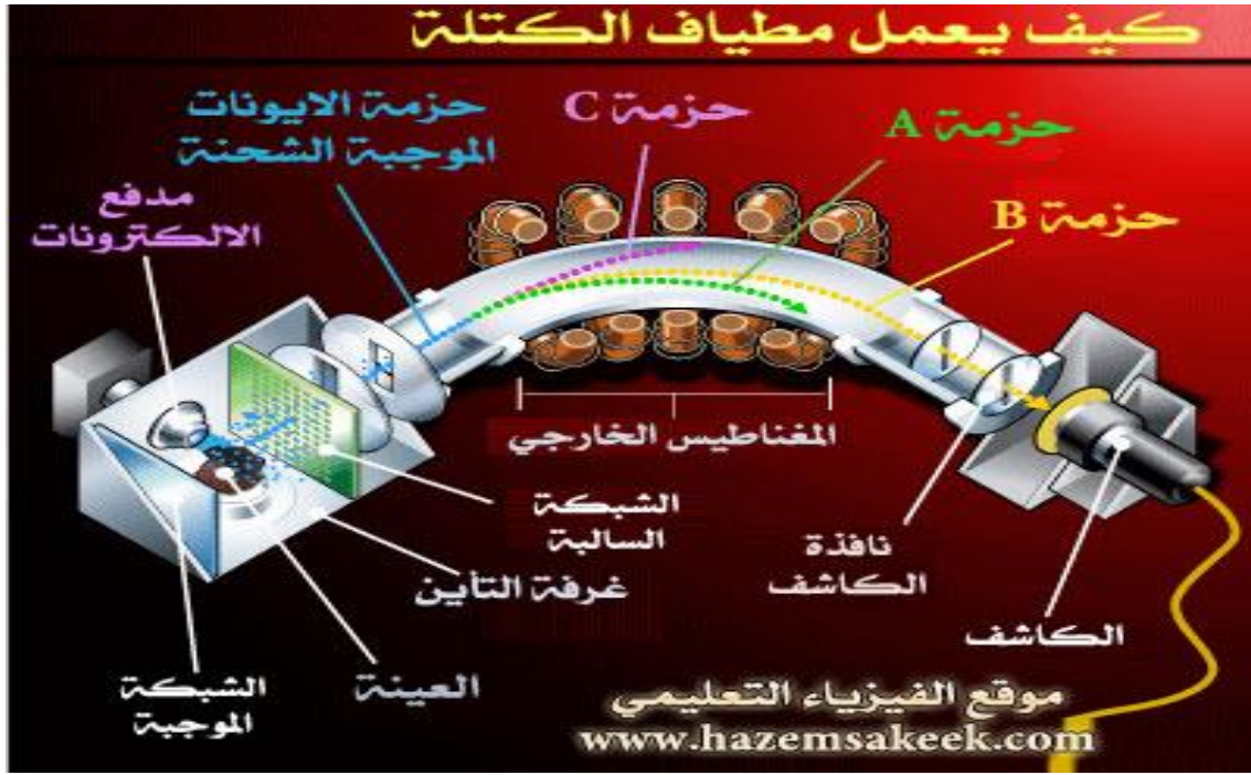
الشكل (II.10) كيفية عمل مطياف الكتلة [35]
