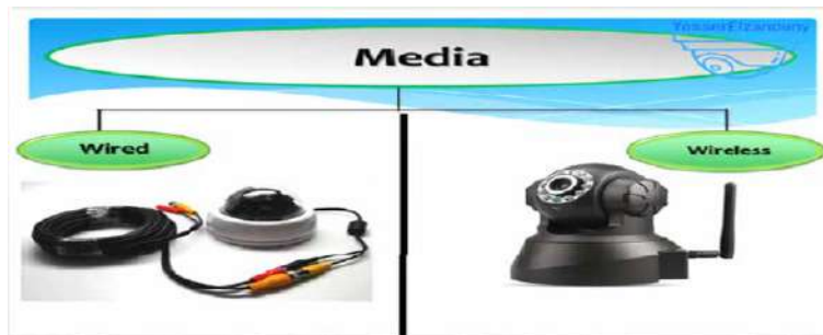
FIGURE 1.10 – la différence entre les caméra qui utilisent des cables et des caméra sans fil[4]
