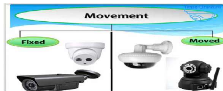
FIGURE 1.9 – La différence entre caméra fixe et mobile[4]
