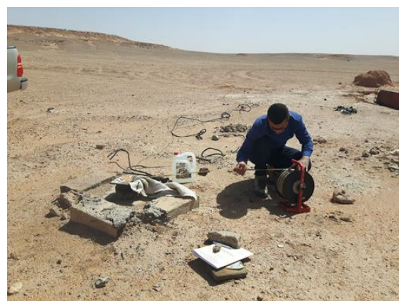
Mesure du niveau piézométrique (PZ 01 - El Menia)
