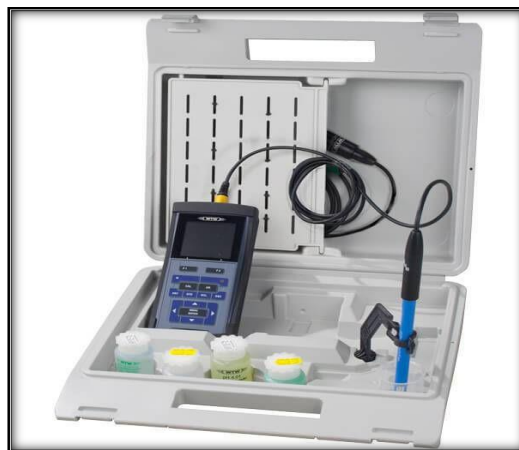
Figure II.03 : Multi-paramètres IDS 3510 pour mesure la conductivité (C.E) et pH
