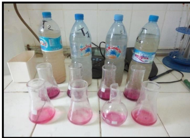
Figure II.05 : Dosage de Calcium \text{Ca}^{2+} et dureté de l'eau TH
