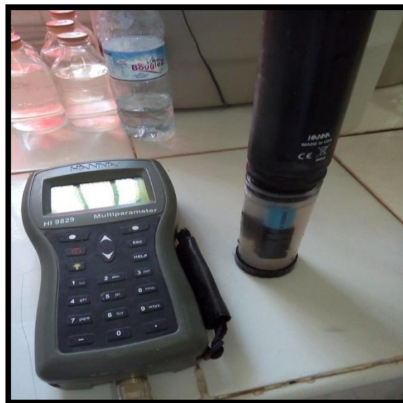
Figure II.04: Mesurer la conductivité (C.E) et pH au Multi-paramètres HI 9829
