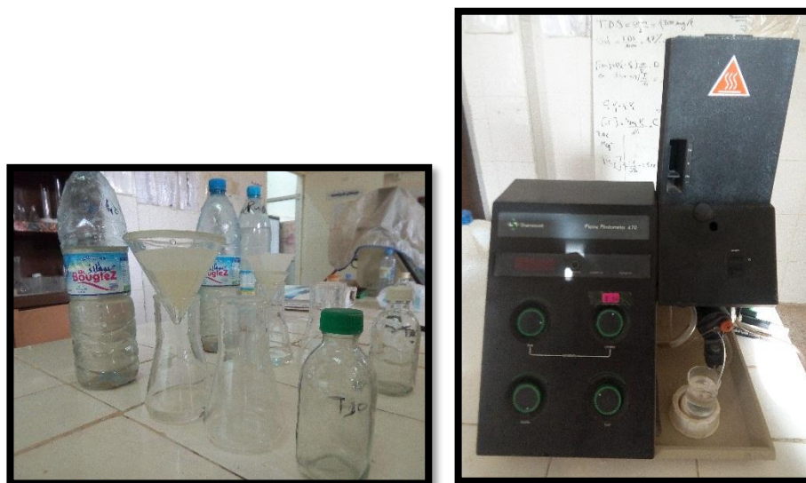
Fig. IV-4 : Dosage du potassium K^+ et du sodium Na^+ par spectrophotomètre à flamme
