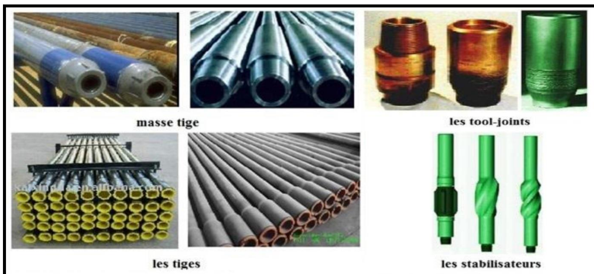
Fig. 23: les composants de la garniture de forage.
