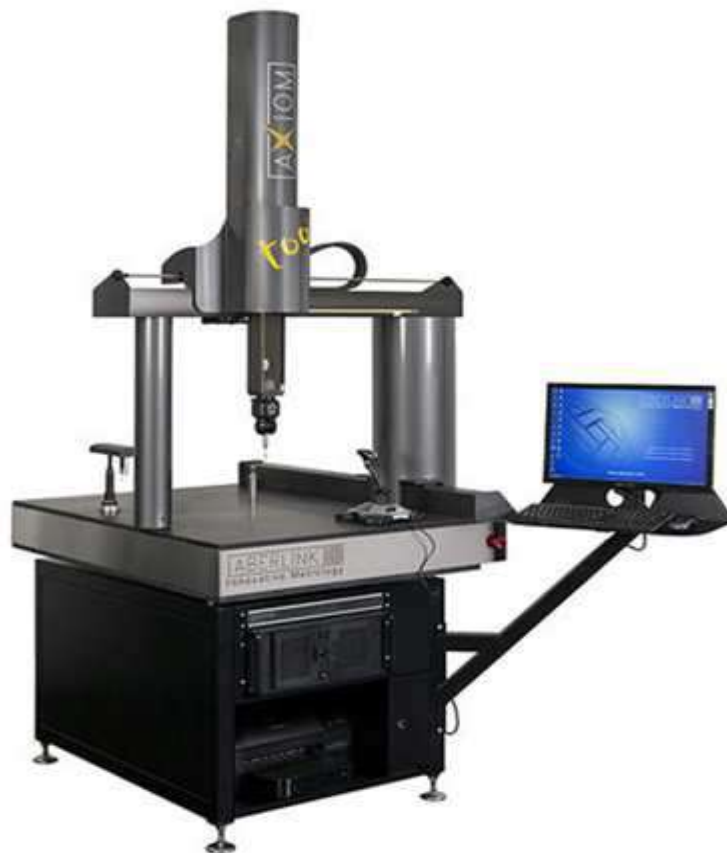
Figure I.18 Appareille de mesure tridimensionnelle [15].
