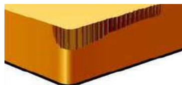
Figure I.11 Usure en dépouille [12].
