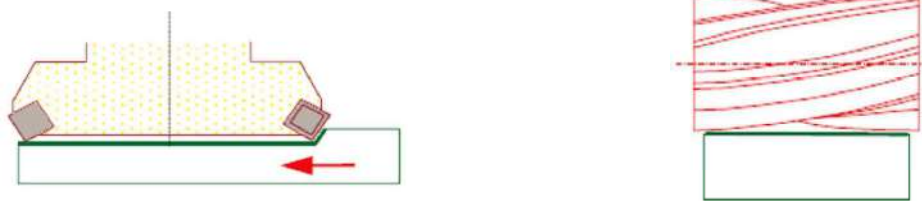
Figure I.3 Fraisage en bout et fraisage en roulant [5].
