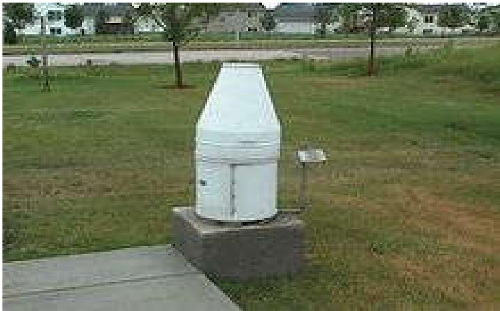
**Figure 14:** Pluviomètre de Fisher et Porter
