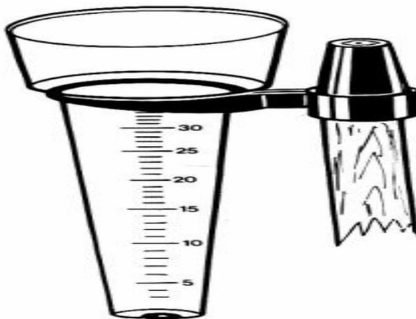
Figure 11: pluviomètre à lecture direct
