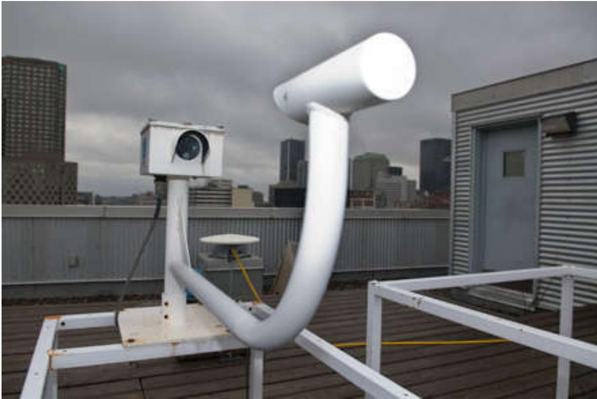
**Figure 15:** Pluviomètre Optique
