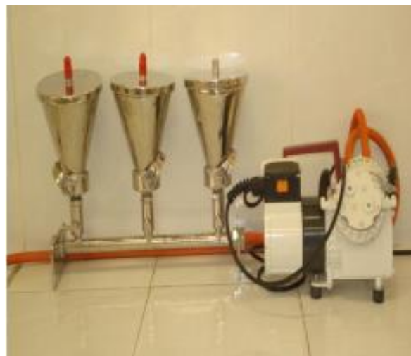
Figure III.13 : Dispositif de filtration sous vide
