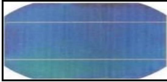
**Figure III. 8:** Cellule poly-cristalline.
