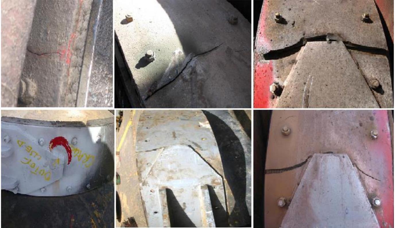
**Figure IV.2 :** Exemple des fissures sur les bandes de frein
