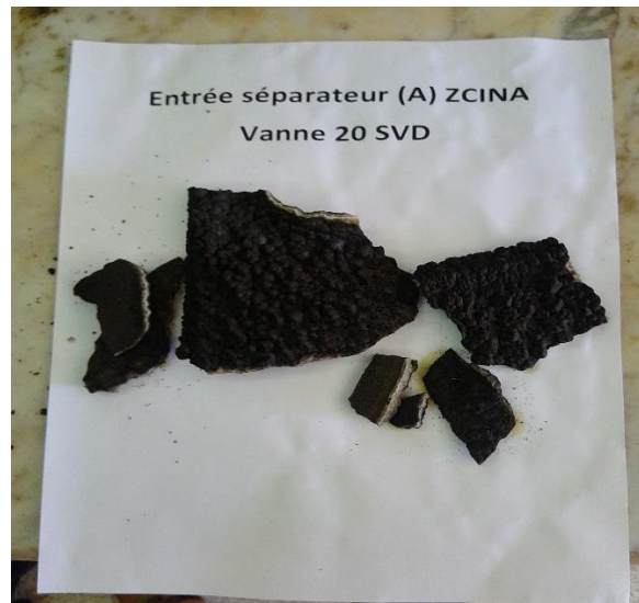
Figure IV.1 : dépôt récupéré à l'entrée de séparateur ZCINA. [17]
