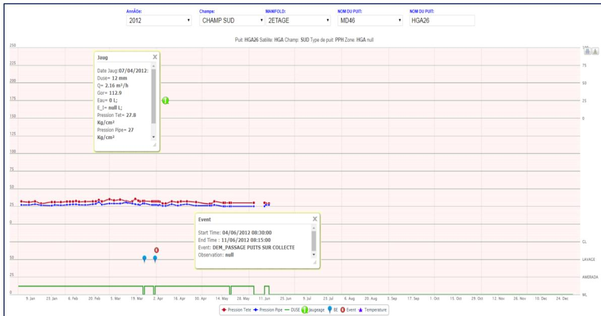
Figure VI.2. Courbe représenté les pressions (Pt et Pp) en fonction de temps.[5]
