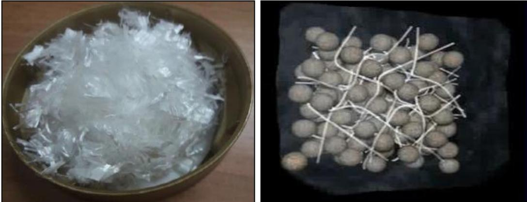
Figure IV.8 : Fibres de fracturation.[19]
