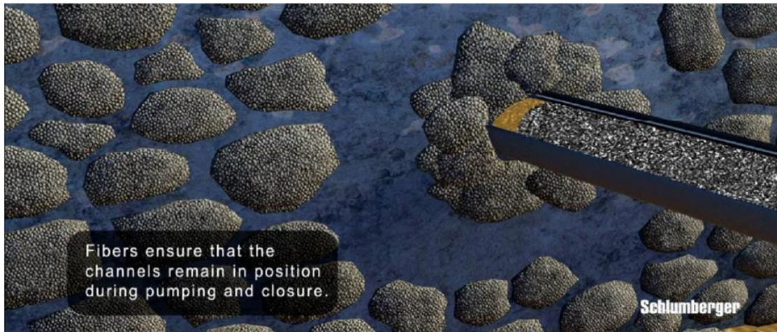
**Figure IV.5 : Pompage intermittent (impulsions propres et dirty).[19]**
