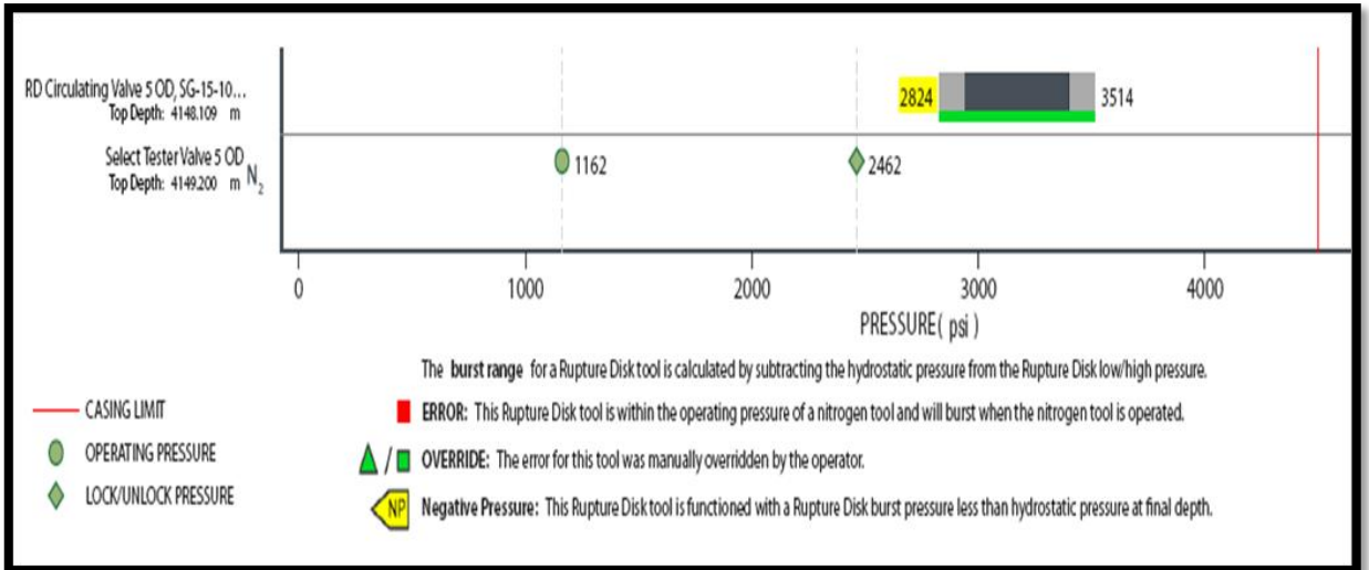
Figure V.5 Pression minimale d'éclatement de RDCV pour une densité d=1,41
