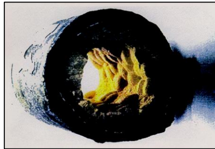
Figure (1.5) : Dépôt de sulfates [III]
