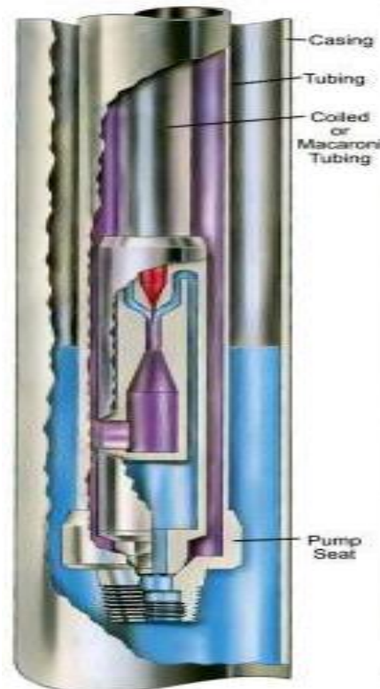
Figure III.13 : Exemple de Jet pompe à l'ancrage fixe.
