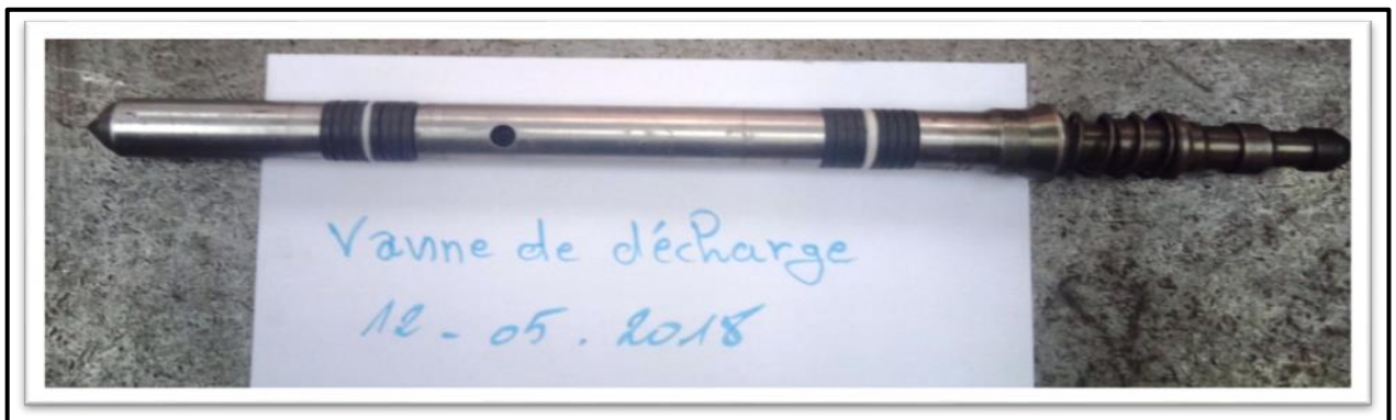
Figure: IV.7. LA VANNE DE GL
