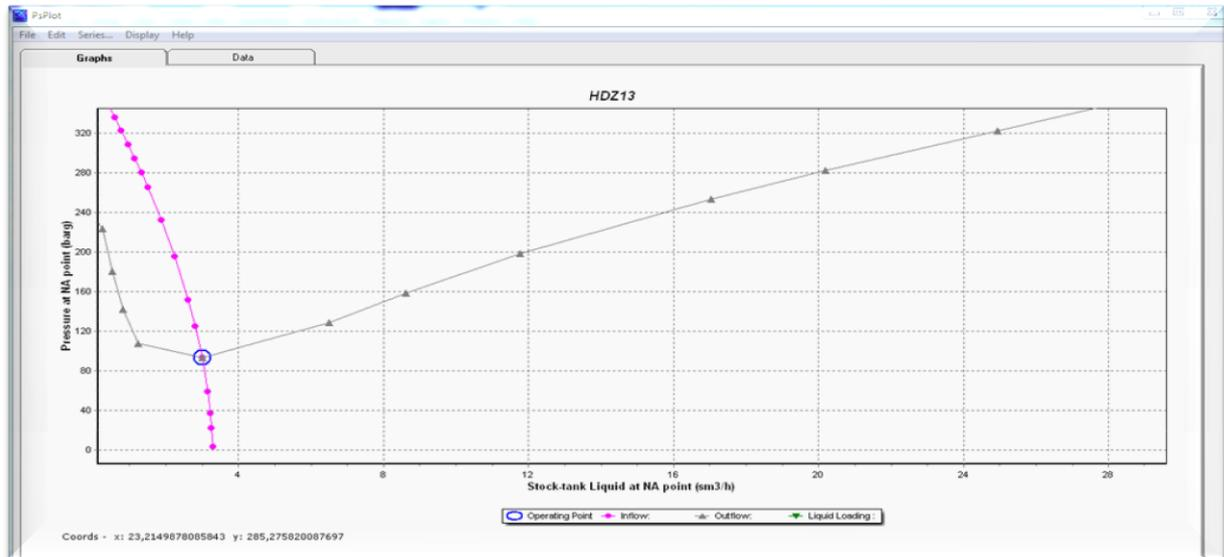
Figure C.1 : Point de fonctionnement du puits HDZ13 après l'actualisation.
