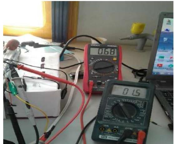
Figure (I 8) : Test de mesure de la tension  $V_{co}$ Figure (I 9) : Test de mesure du courant  $I_{cc}$
