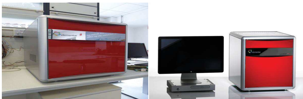
Figure(III.7) : Analyseur de combustion CHNS simultané moderne
