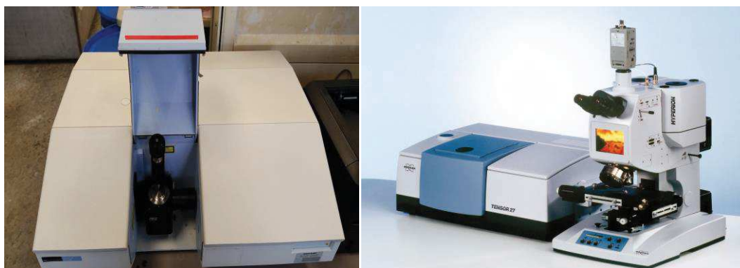
Figure (III.6) : La spectroscopie infrarouge à transformée de Fourier (FTIR) [68]
