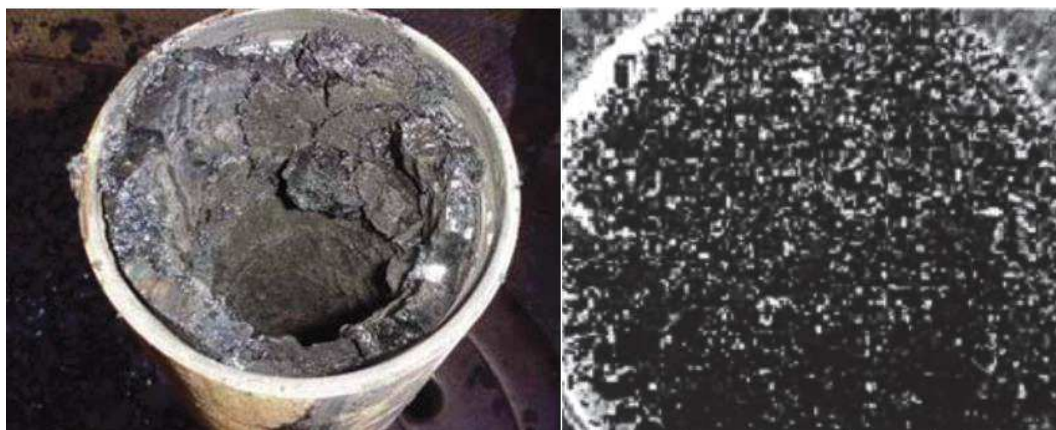
Figure (II.02): Asphaltènes obstruant un tuyau.
