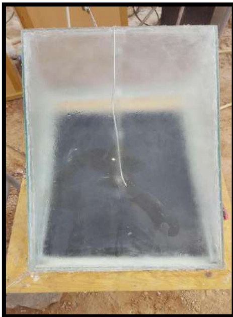
Figure III.1. Conception du distillateur solaire utilisé dans l'expérience
