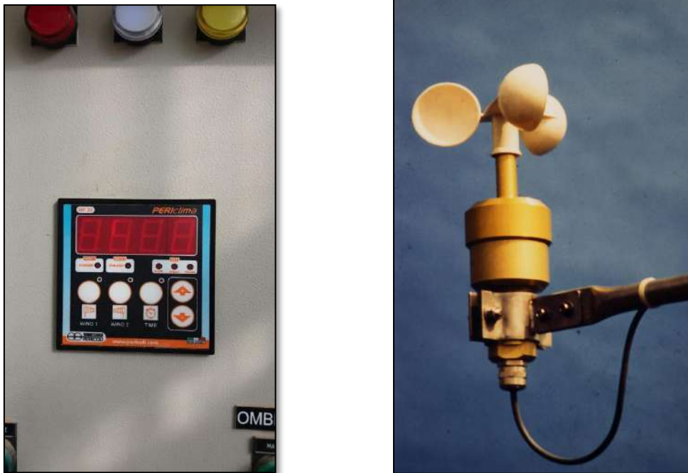
Figure.III.4 : Anémomètre à coupelles (dit de Robinson)
