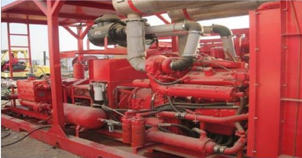
Fig.II.14 : La pompe de pression de retour [19].
