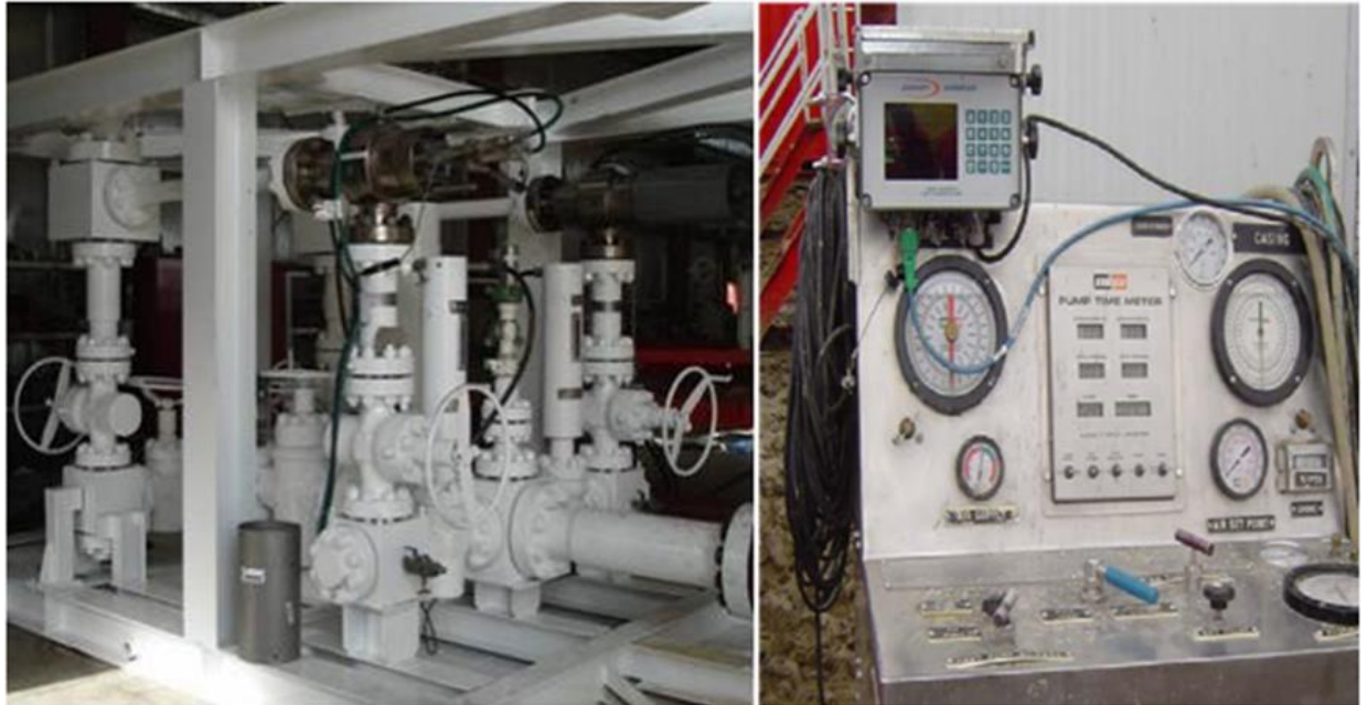
Fig.II.13 : Le choke manifold à commande semi-automatique [16].
