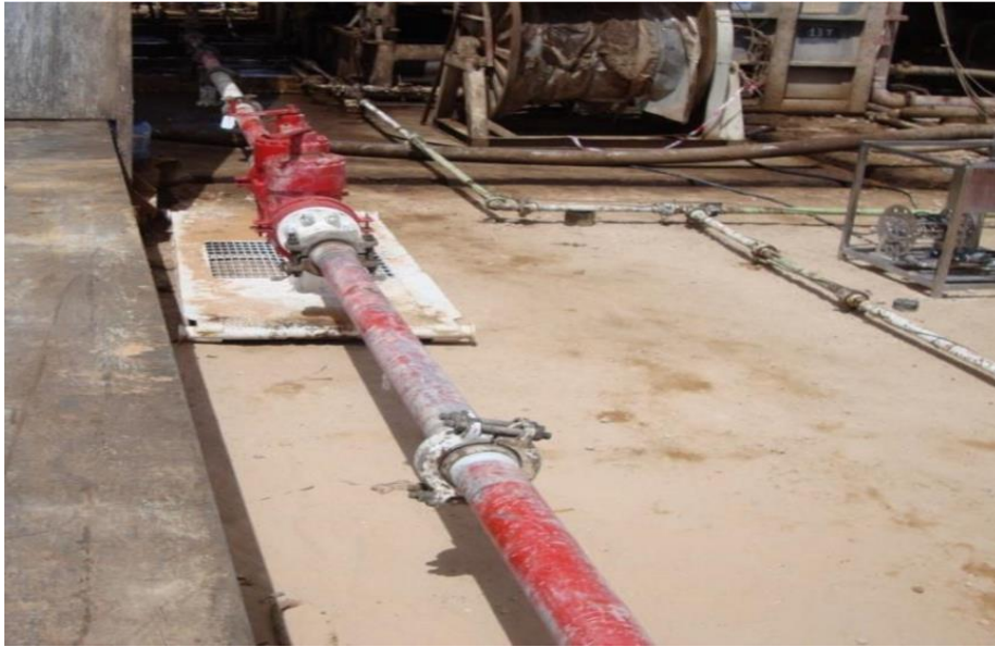
Fig.II.11 : La conduite de retour (Flow Line).
